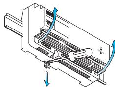
Montaje mediante tornillos
