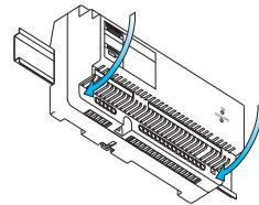
Desmontaje del carril DIN
