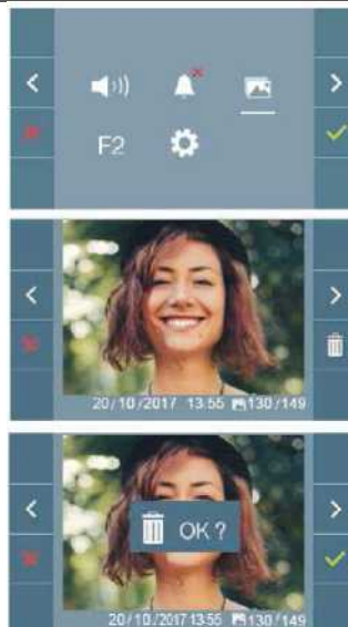
Автоматический захват изображения при звонке посетителя (PHOTOCALLER)
